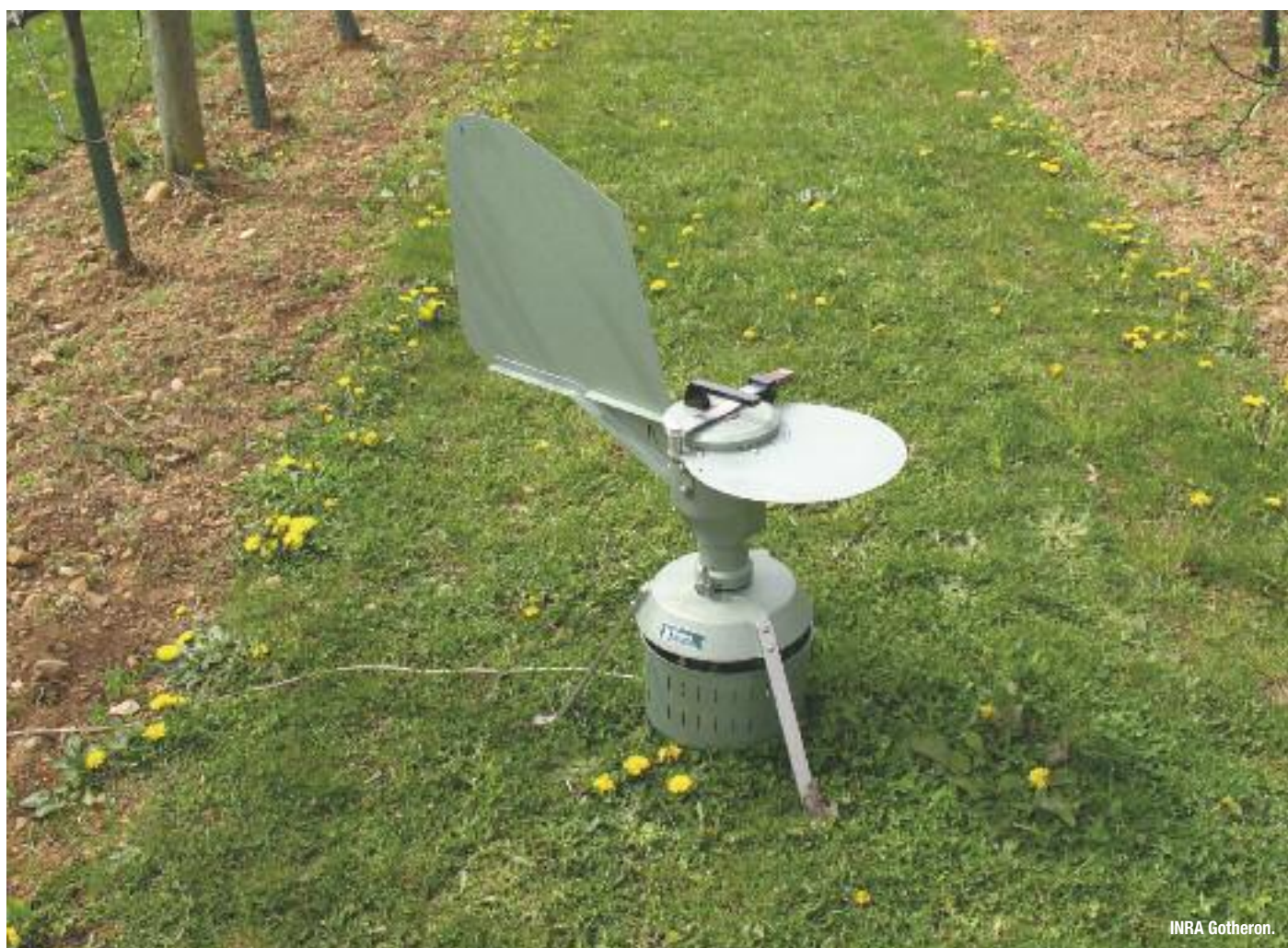
Piège à projections d'ascospores de Tavelure BURKARD ®
