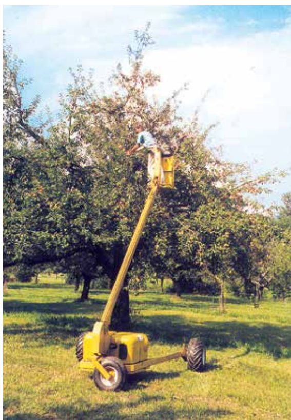
Plus sûres et pratiques que les échelles usuelles : les échelles hydrauliques sont rentables dans les grands vergers pour les travaux d'entretien et de récolte.
